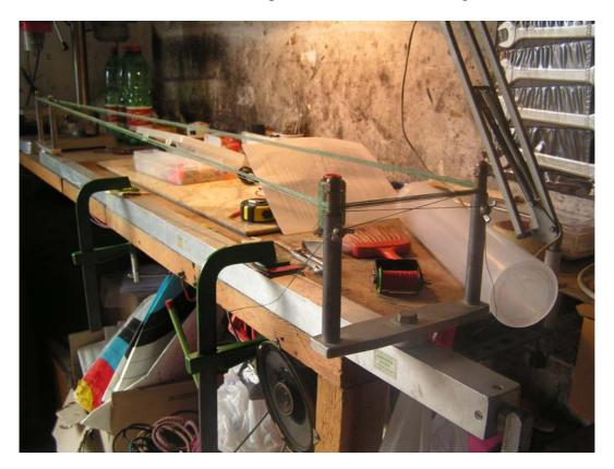
Avvolgere il teflon sulla corda lungo la parte girata della macchina in modo da chiudere l'avvolgimento della corda, essendo questo il loop superiore fare un avvolgimento largo quasi per tutta la lunghezza della corda girata, con non meno di 3 passaggi di teflon (attenzione avvolgere il teflon in modo da non srotolare tutto il nastro ma girarlo nel senso di rotazione in modo che si possa gestire nei giri di avvolgimento).
